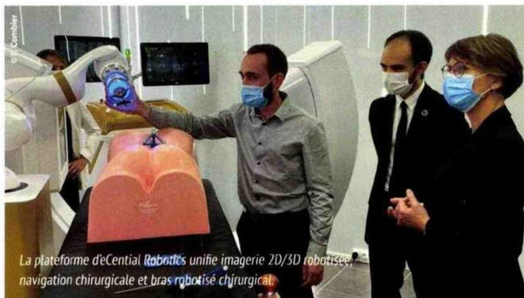
La plateforme d'eCential Robotics unifie imagerie 2D/3D robotisée, navigation chirurgicale et bras robotisé chirurgical.
